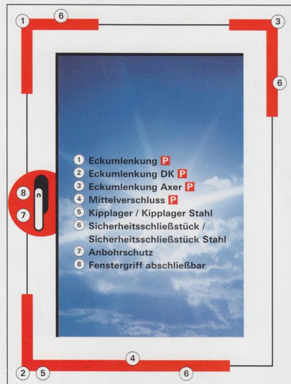
**Die Widerstandsklasse 1\*** leistet harten Widerstand gegen Versuche, das Fenster auszuhebeln. Mit Hilfe von spezifischen NT-Sicherheitsbauteilen wird hier ein anspruchsvolles Sicherheitsniveau erreicht: Sicherheitsschließstücke und Eckumlenkungen mit Pilzzapfen geben dem Fenster oder der Fenstertür an vier Ecken mehr Aushebelschutz. Der notwendige Bohrschutz und der abschließbare Fenstergriff erhöhen zusätzlich das Sicherheitsniveau.
