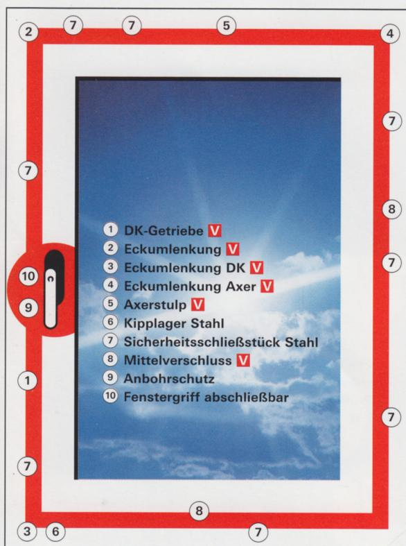
**Die Widerstandsklasse 2\*** der mechanischen Absicherung baut auf der Klasse 1 auf. Zusätzlich verstärken spezielle Sicherheitsbauteile mit hintergreifenden Pilzzapfen rund um den Flügel die Verbindung zwischen Fensterflügel und Fensterrahmen. Das heißt: Beschlag und Fensterrahmen halten stärkeren Belastungen stand.
